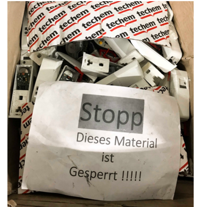
Heizmessgeräte werden zur Seite gelegt und beschriftet. (Foto: GADPlus)
