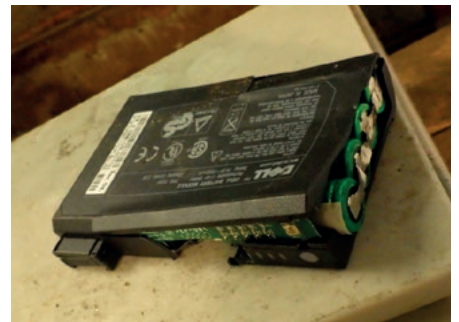
Beispiele defekter LIB aus den Swico-Mix-Batchtests: einzelne Zelle (oben) und Laptop-Batterie (unten)
