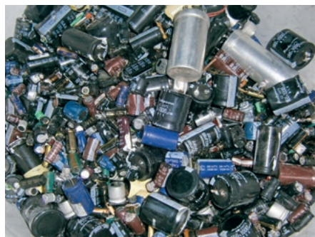
Kondensatoren aus der manuellen Zerlegung
